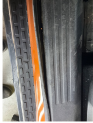
Kapı, sol ön, Kapı fitili > Hasarlı
