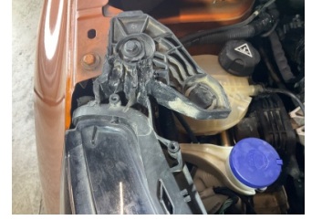
Farlar, Far camı, sağ > Standart Dışı Onarım
