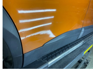
Kapı, sağ arka, Kapı, sağ arka > Hasarlı
