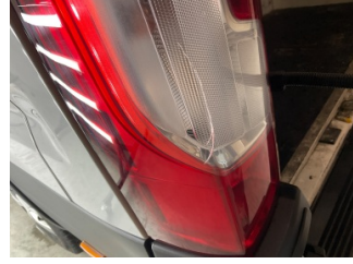
Arka lambalar, Arka lamba camı, sol > Çatlak
