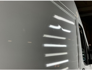
Kapı, sağ arka, Kapı, sağ arka > Ezik
