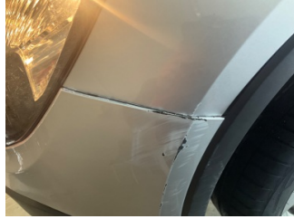
Tampon, ön, Ön tampon > Sabitlemesi Hatalı
