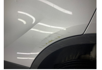
Kapı, sol arka, Kapı, sol arka > Çizik
