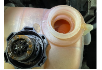
Motorsoğutması, Soğutma sıvısı > Kirlenmiş
