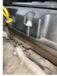
Motor, Külbütör kapağı contası > Yağ Kaçağı
