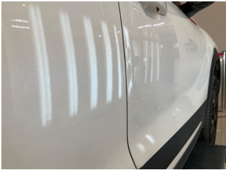
Kapı, sağ ön, Kapı, sağ ön > Ezic
