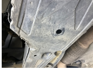
Motor, Alt muhafaza > Hasarlı
