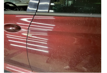
Kapı, sol arka, Kapı, sol arka > Çizik
