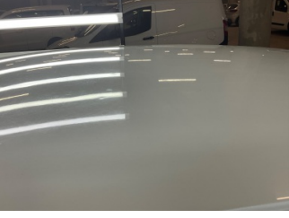
Tavan, Tavan > Dolu Hasarı
