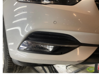
Tampon, ön, Ön tampon > Çatlak
