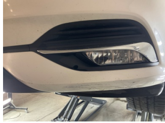
Tampon, ön, Ön tampon > Çatlak
