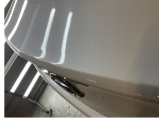
Bagaj kapağı/kapısı, Bagaj kapısı > Noktasal Ezik
