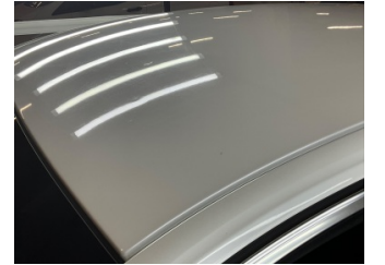
Tavan, Tavan > Dolu Hasarı
