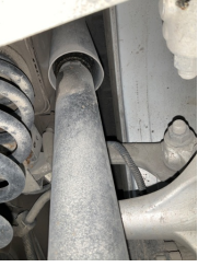
Arka aks, Amortisör, arka sağ > Yağ Kaçağı
