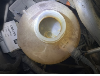
Motorsoğutması, Soğutma sıvısı > Eksik
