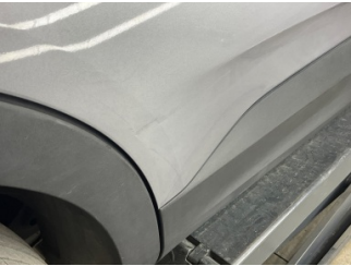
Çamurluk, sağ arka, Çamurluk, sağ arka > Ezik
