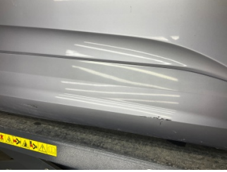
Kapı, sağ ön, Kapı bandı > Çizik
