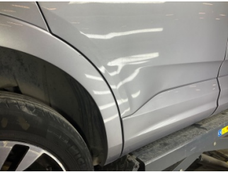
Kapı, sağ arka, Kapı, sağ arka > Ezik
