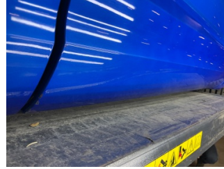
Kapı, sağ ön, Kapı bandı > Çizik
