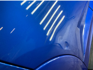
Kapı, sağ arka, Kapı, sağ arka > Ezik
