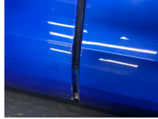
Kapı, sol ön, Kapı bandı > Küçük Çizik
