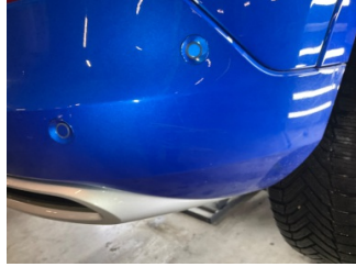
Tampon, arka, Arka tampon > Küçük Çizik
