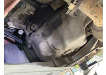
Motor, Motor > Yağ Kaçağı
