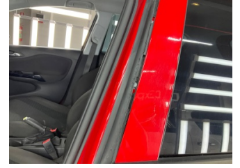
Kapı, sol ön, Kapı fitili > Hasarlı
