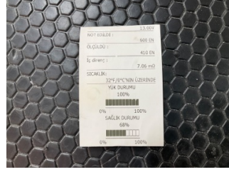
Elektrik donanımı/Pano, Akü > Test Sonucu
