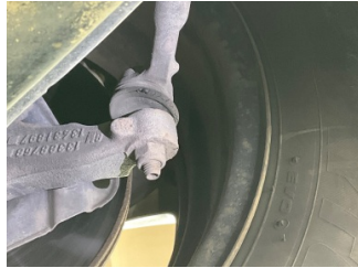
Direksiyon sistemi, Rot kolu/Rot başı, sağ > Hasarlı
