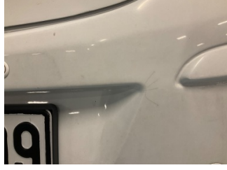
Tampon, arka, Arka tampon > Çatlak
