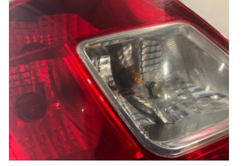
Arka lambalar, Arka lamba camı, sol > Çatlak
