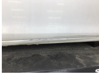
Marşbiyel, sağ, Marşbiyel, sağ > Hasarlı
