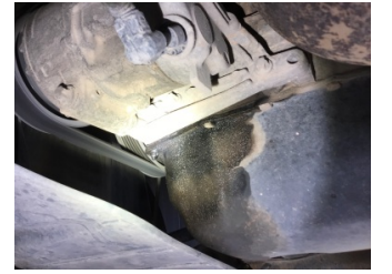
Motor, Motor > Yağ Kaçağı
