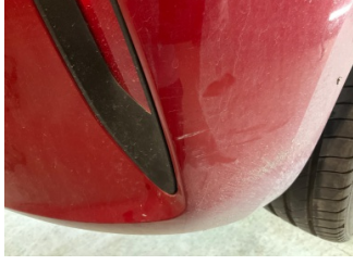
Tampon, arka, Arka tampon > Küçük Çizik
