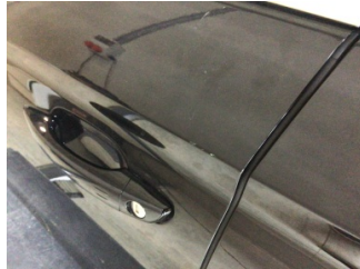
Kapı, sol ön, Kapı, sol ön > Çizik
