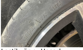
Lastik, ön > Hasarlı
