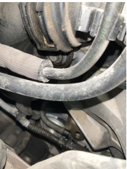
Motor, Turbo hortumları > Yağ Kaçağı
