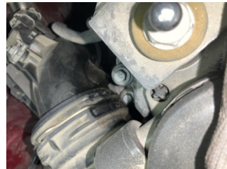
Motor, Turbo hortumları > Yağ Kaçağı
