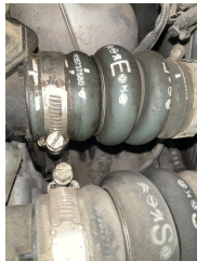
Motor, Turbo hortumları > Yağ Kaçağı
