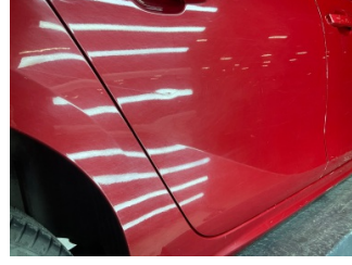
Kapı, sağ arka, Kapı, sağ arka > Ezik
