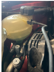
Motorsöğütması, Soğutma sıvısı > Eksik
