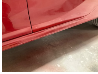
Marşbiyel, sol, Marşbiyel, sol > Hasarlı
