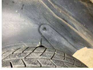
Çamurluk, sol arka, Davlumbaz > Kırılmış
