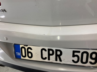
Tampon, arka, Arka tampon > Boyası Atmış
