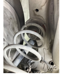
Arka aks, Süspansiyon, arka sağ > Hasarlı
