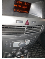
Kalorifer/Klima, Havalandırma ızgarası > Kırılmış
