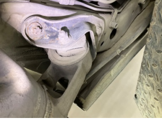
Arka aks, Arka aks travers burçları > Hasarlı
