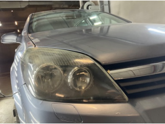
Farlar, Far camı, sağ > Deforme Olmuş
