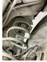
Arka aks, Süspansiyon, arka sağ > Hasarlı
