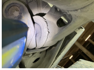
Arka aks, Arka aks travers burçları > Hasarlı
