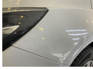
Çamurluk, sol, Çamurluk, sol > Yakıcı Madde ile Zarar Görmüş
