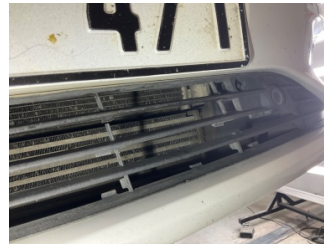
Tampon, ön, Ön tampon ızgarası > Hasarlı
