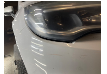
Tampon, ön, Ön tampon > Sabitlemesi Hatalı
