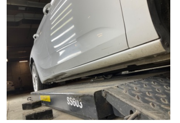
Marşbiyel, sağ, Marşbiyel, sağ > Hasarlı
