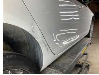
Kapı, sağ arka, Kapı, sağ arka > Hasarlı
