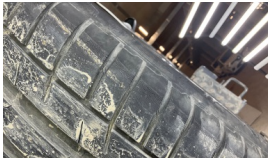
Lastik, sağ arka > Hasarlı
