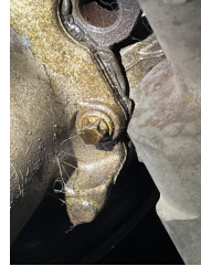
Motor, Motor > Yağ Kaçağı
