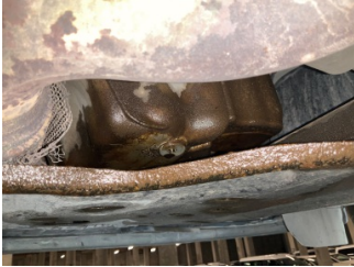
Motor, Motor > Yağ Kaçağı
