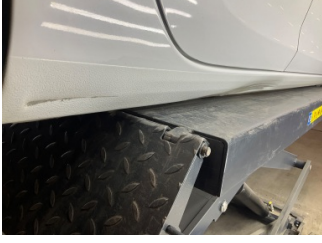
Marşbiyel, sağ, Marşbiyel, sağ > Hasarlı
