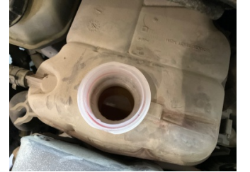
Motorsoğutması, Soğutma sıvısı > Kirlenmiş
