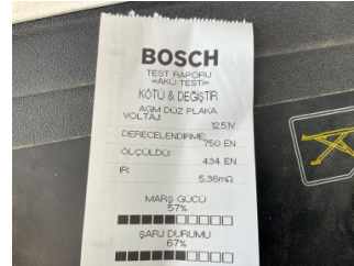
Elektrik donanımı/Pano, Akü > Test Sonucu
