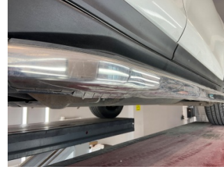
Marşbiyel, sağ, Marşbiyel, sağ > Hasarlı
