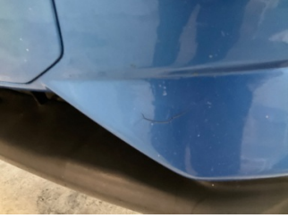
Tampon, ön, Ön tampon > Çatlak
