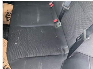
Döşemeler/Kapaklar, Döşemeler/Kapaklar > Yakıcı Madde ile Zarar Görmüş
