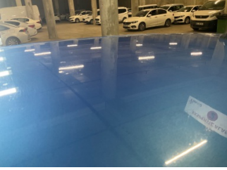
Tavan, Tavan > Dolu Hasarı
