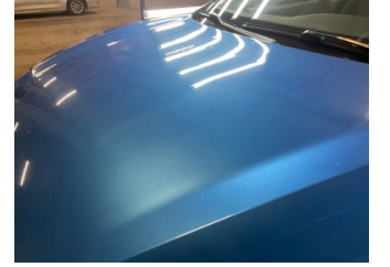
Motor kaputu, Motor kaputu > Dolu Hasarı
