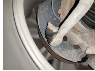
Direksiyon sistemi, Rot kolu/Rot başı, sol > Hasarlı
