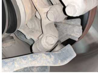
Ön aks, Salıncak, ön sol alt > Hasarlı
