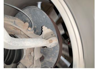
Direksiyon sistemi, Rot kolu/Rot başı, sağ > Hasarlı
