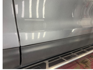
Kapı, sağ ön, Kapı, sağ ön > Çizik
