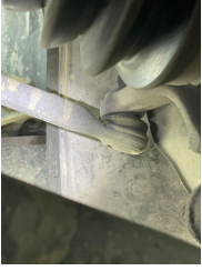
Direksiyon sistemi, Rot kolu/Rot başı, sol > Hasarlı
