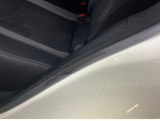
Kapı, sol arka, Kapı fitili > Delinmiş
