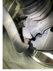
Ön aks, Salıncak, ön sağ üst > Hasarlı
