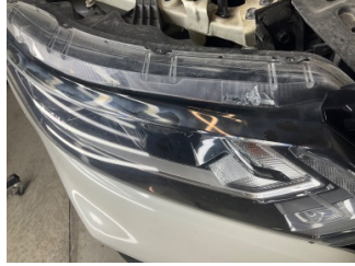
Farlar, Far camı, sağ > Deforme Olmuş
