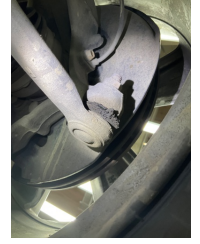
Direksiyon sistemi, Rot kolu/Rot başı, sağ > Hasarlı
