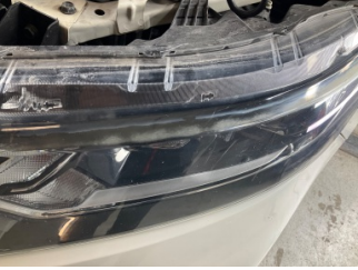
Farlar, Far camı, sol > Deforme Olmuş
