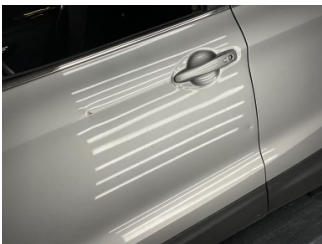
Kapı, sol ön, Kapı, sol ön > Ezik
