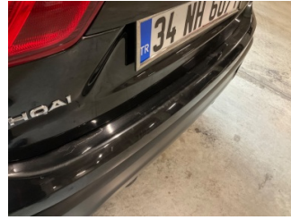
Tampon, arka, Arka tampon > Boyası Atmış
