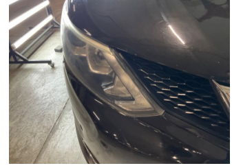
Farlar, Far camı, sağ > Deforme Olmuş
