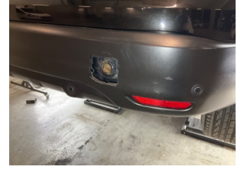
Tampon, arka, Çeki demir kapağı > Sökülmüş-Yok
