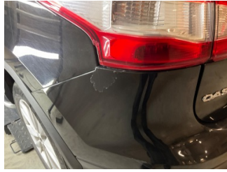
Tampon, arka, Arka tampon > Boyası Atmış
