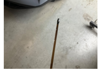
Motor, Yağ seviyesi > Eksik
