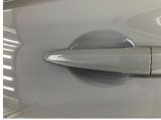
Kapı, sol arka, Kapı kolu, dış > Çizik
