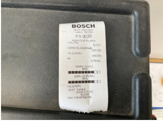
Elektrik donanımı/Pano, Akü > Test Sonucu
