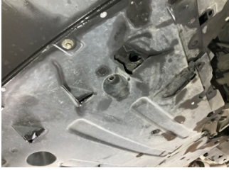
Motor, Alt muhafaza > Hasarlı
