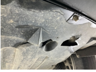
Motor, Alt muhafaza > Hasarlı
