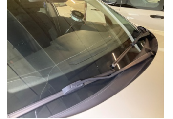
Camlar, Ön cam > Hasarlı
