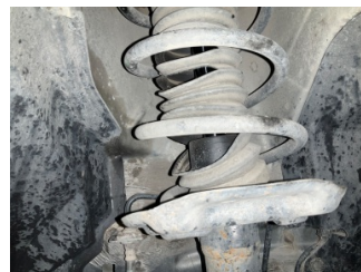
Ön aks, Amortisör körüğü, sağ > Hasarlı
