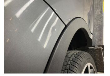
Çamurluk, sağ arka, Çamurluk, sağ arka > Ezik
