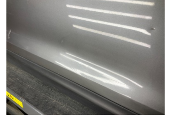
Kapı, sağ ön, Kapı, sağ ön > Çizik
