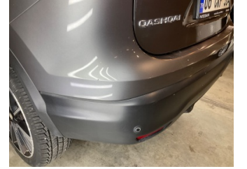
Tampon, arka, Bağlantı ayağı > Çizik
