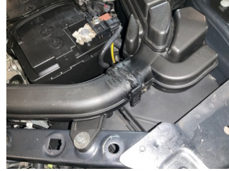
Motor, Hava filtresi kabı > Standart Dışı Onarım
