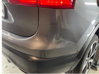
Tampon, arka, Bağlantı ayağı > Çizik
