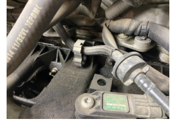
Motor, Külbütör kapağı > Yağ Kaçağı
