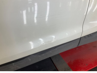
Kapı, sol ön, Kapı, sol ön > Hasarlı
