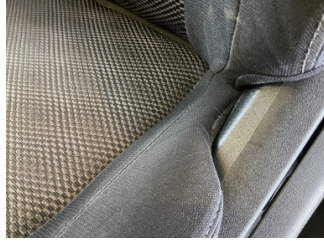
Döşemeler/Kapaklar, Döşemeler/Kapaklar > Deforme Olmuş
