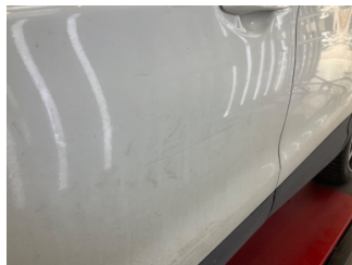
Kapı, sol ön, Kapı, sol > Ezik
