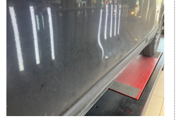
Kapı, sol ön, Kapı, sol ön > Ezik
