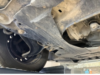
Motor, Alt muhafaza > Hasarlı
