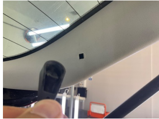
Döşemeler/Kapaklar, Pandizot > Sabitlemesi Hatalı
