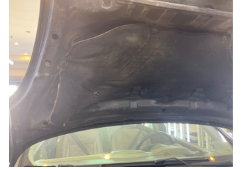
Motor kaputu, İzolasyon döşemesi > Deforme Olmuş
