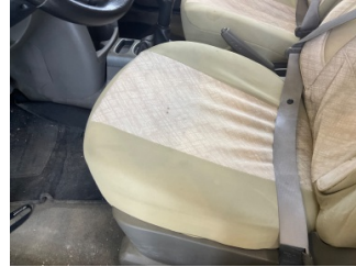
Döşemeler/Kapaklar, Döşemeler/Kapaklar > Yakıcı Madde ile Zarar Görmüş
