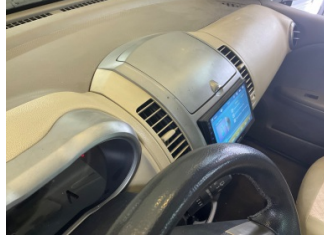
Döşemeler/Kapaklar, Döşemeler/Kapaklar > Deforme Olmuş
