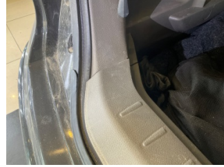
Kaporta, Bagaj kapağı fitili > Hasarlı
