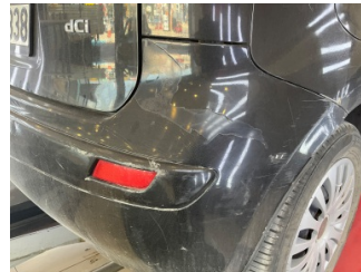
Tampon, arka, Arka tampon > Boyası Atmış
