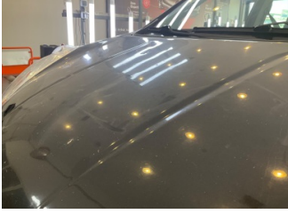
Motor kaputu, Motor kaputu > Dolu Hasarı
