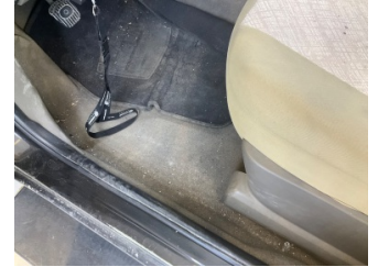
Döşemeler/Kapaklar, Döşemeler/Kapaklar > Yakıcı Madde ile Zarar Görmüş
