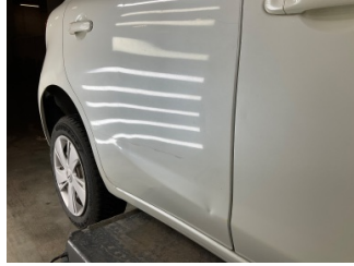
Kapı, sağ arka, Kapı, sağ arka > Ezik
