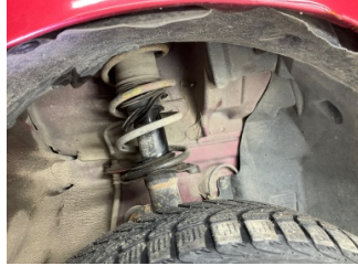
Ön aks, Amortisör körüğü, sağ > Hasarlı
