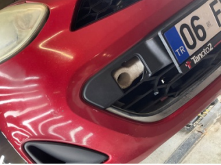
Tampon, ön, Çeki demir kapağı > Sökülmüş-Yok
