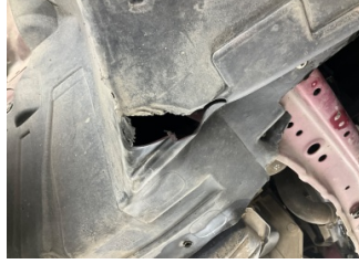
Çamurluk, sağ, Davlumbaz > Kırılmış
