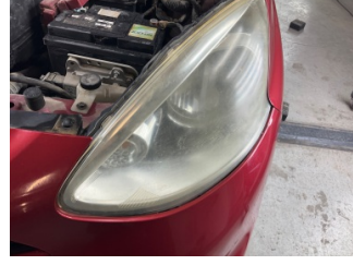
Farlar, Far camı, sol > Deforme Olmuş
