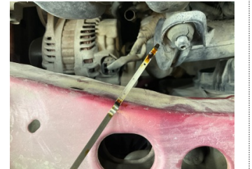
Motor, Yağ seviyesi > Eksik
