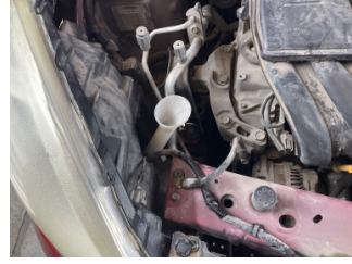
Cam yıkama/silme sistemi, Cam suyu bidonu kapağı > Sökülmüş-Yok
