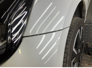
Tampon, ön, Ön tampon > Sabitlemesi Hatalı
