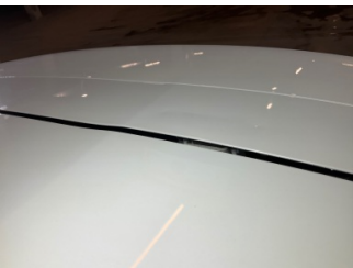
Bagaj kapağı/kapısı, Bagaj kapısı > Ezik
