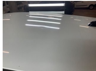
Tavan, Tavan > Dolu Hasarı
