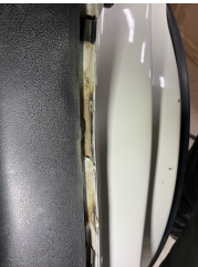
Kaporta, C-direk, sol > Standart Dışı Onarım
