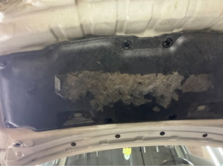
Motor kaputu, izolasyon döşemesi > Hasarlı
