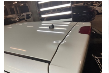
Komünikasyon/Navigasyon/Eğlence sistemleri, Anten > Hasarlı
