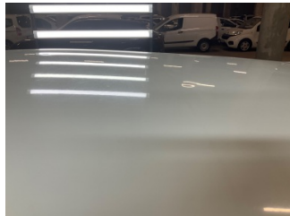
Tavan, Tavan > Dolu Hasarı
