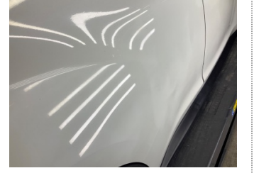
Kapı, sağ arka, Kapı, sağ arka > Ezik
