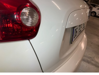
Bagaj kapağı/kapısı, Bagaj kapısı > Ezik
