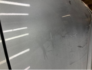
Kapı, sol arka, Kapı, sol arka > Çizik
