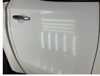
Kapı, sağ arka, Kapı, sağ arka > Ezik
