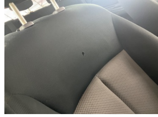
Döşemeler/Kapaklar, Döşemeler/Kapaklar > Yakıcı Madde İle Zarar Görmüş
