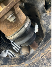
Ön aks, Aks mili, toz körüğü, sağ > Hasarlı
