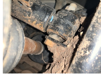
Ön aks, Amortisör körüğü, sol > Hasarlı
