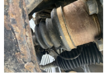
Ön aks, Aks mili, toz körüğü, sol > Hasarlı
