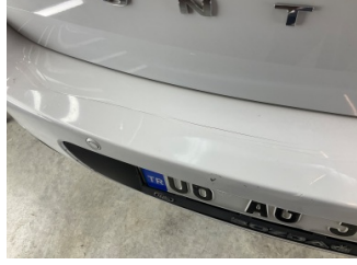
Tampon, arka, Arka tampon > Çatlak
