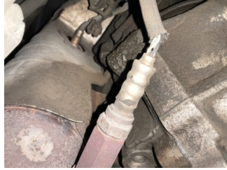
Motor, Motor > Yağ Kaçağı
